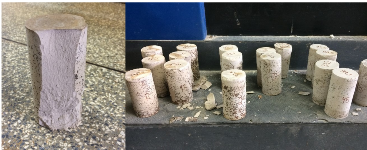
Figura 12: Corpos de prova rompidos
