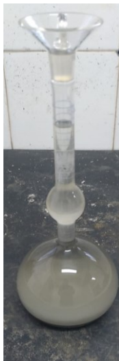
Figura 5: Frasco de Chapman usado para determinação de massa específica.
