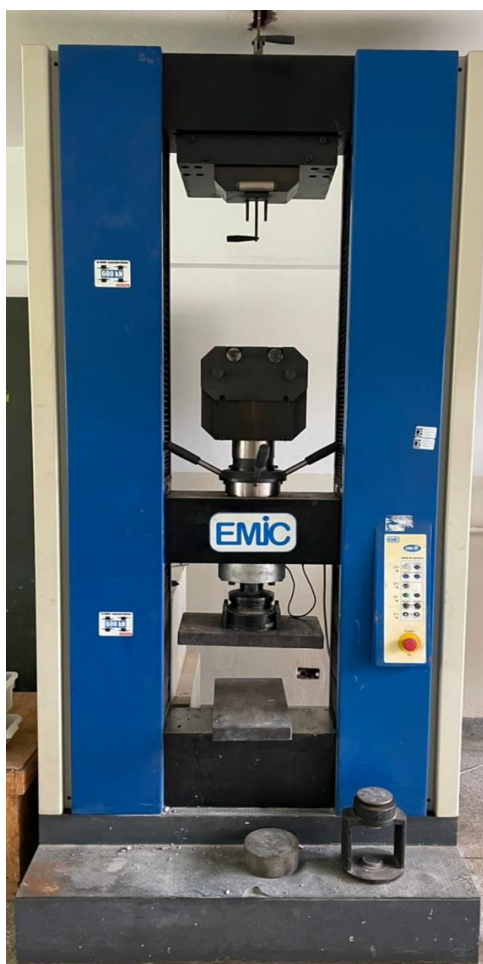
Figura 11: Aparelho utilizado no ensaio de compressão
