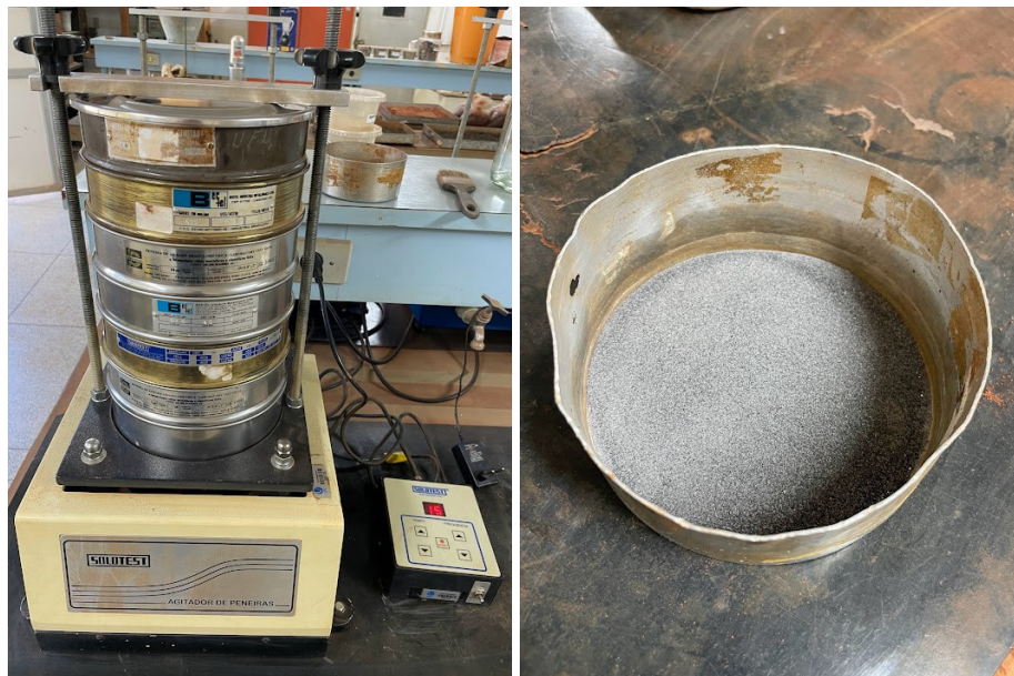
Figura 8: Peneiramento fino da amostra segundo ABNT NBR 7181:2016 (a) Conjunto de peneiras (b) Amostra peneirada (Fonte: Autor, 2022)
