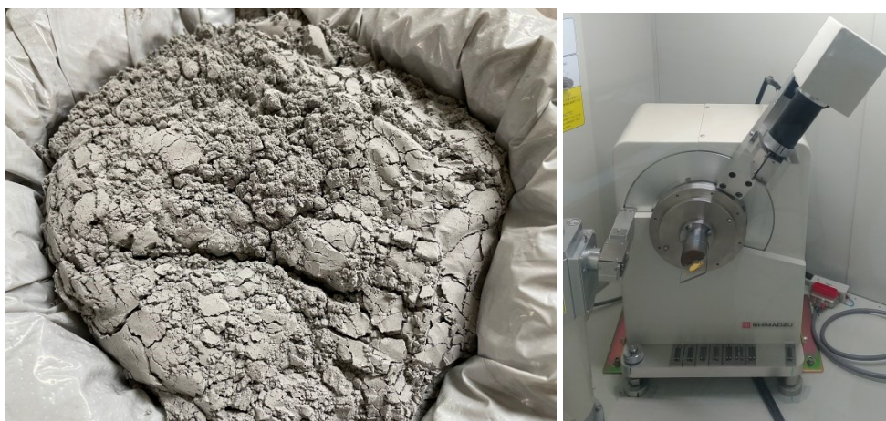
Figura 2 - a) Material seco b) Equipamento utilizado no ensaio de DRX.
