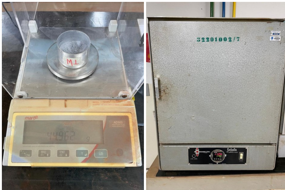
Figura 9: Experimento de teor de umidade segundo ABNT NBR 6457:2016. (a) Amostra seca ao ar (b)
