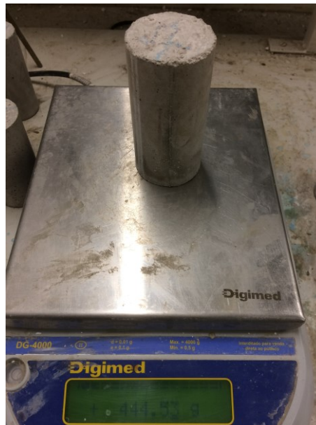
Figura 10: Corpo de prova cilíndrico após deforma e cura.
