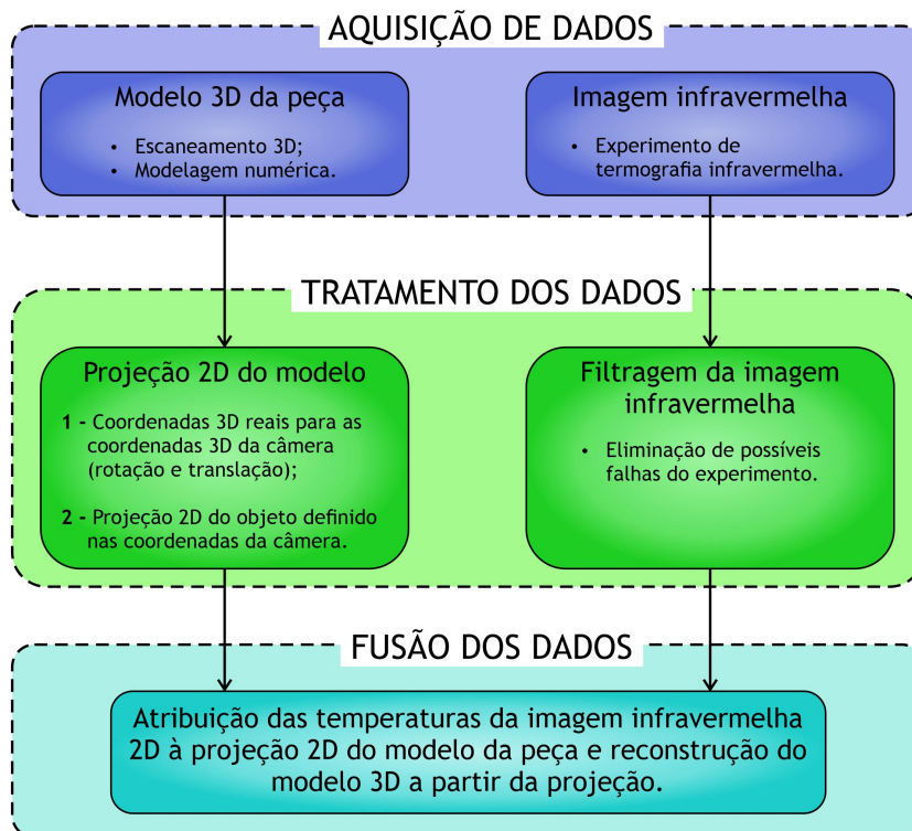
Figura 6 – Procedimentos para fusão de dados no contexto da termografia infravermelha.
