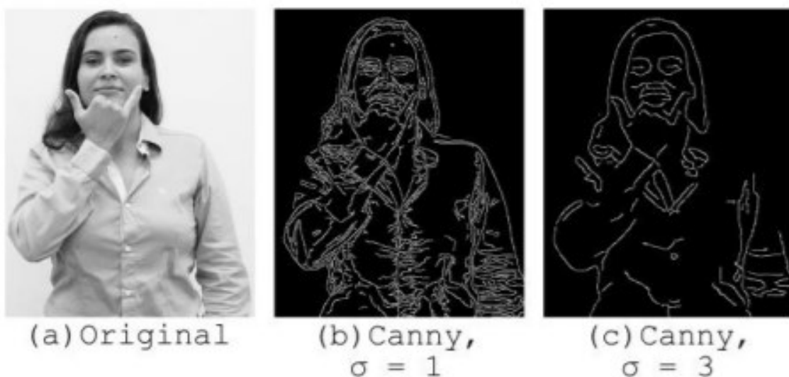
Figura 12 - Detecção de bordas Canny
