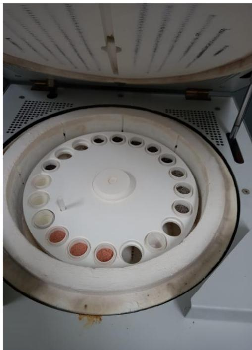
Então, conforme apresentado na Figura 6, a máquina solicita que as tampas sejam adicionadas em todos os cadinhos e realiza a última pesagem e o experimento tem início.
