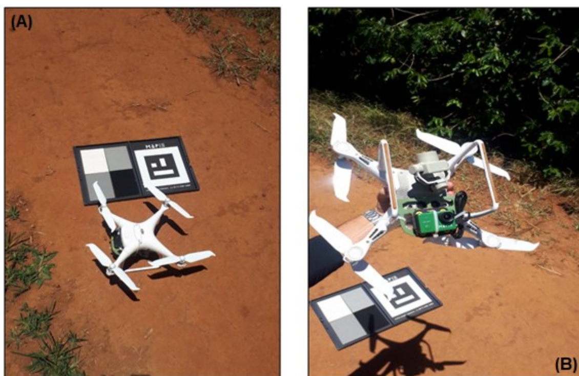
Figura 8 – (A) ARP Phantom 4 Advanced . (B) Câmera Mapiir acoplada a ARP
