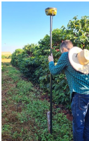
Figura 9 – Receptor GNSS ( Rover ) utilizados no georreferenciamento das parcelas experimentais.
