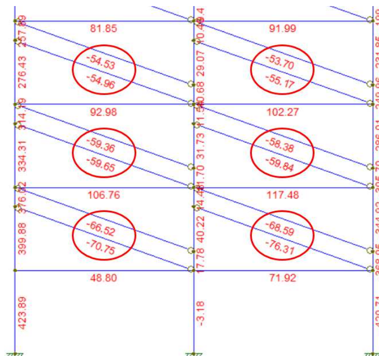
Figura 52 – Esforços de compressão nas diagonais dos primeiros andares para o modelo Durrani e Luo 2D
