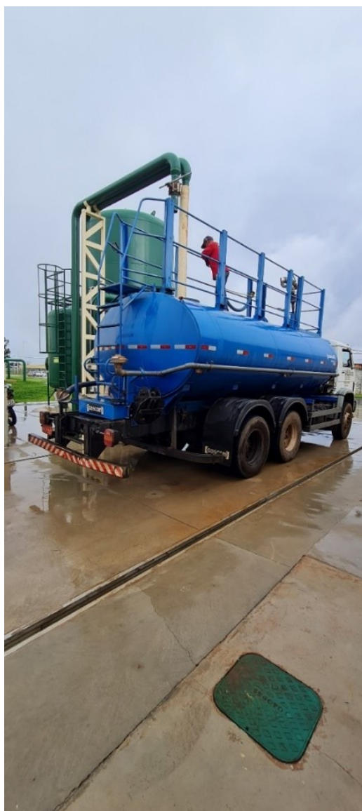
Figura 10: Abastecimento do caminhão pipa com água bruta.
