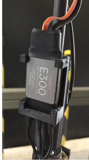
Figura 9 – Foto de um controlador eletrônico de velocidade utilizado no trabalho.
