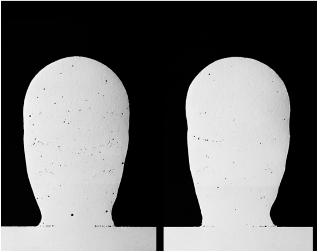
Figura 3: Exemplos de porosidade em amostras depositadas por MA.
