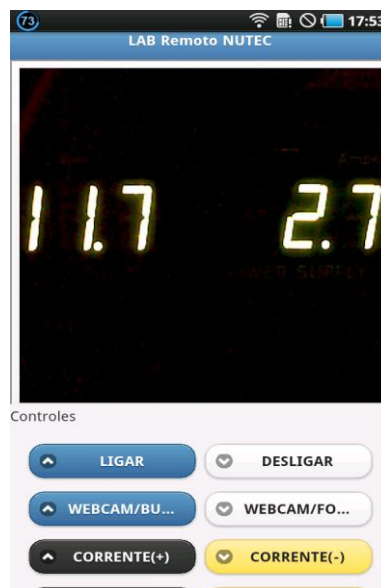
Figura 4: Ambiente virtual de acesso ao experimento remoto visto a partir de um aparelho celular com sistema operacional Android.
