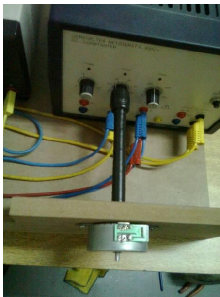
Figura 6: Motor de passo que executa a ação do usuário a um potenciômetro de uma fonte de tensão.
