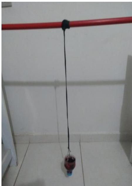
Figura II: Estrutura do pêndulo desenhista com um ponto de apoio.
