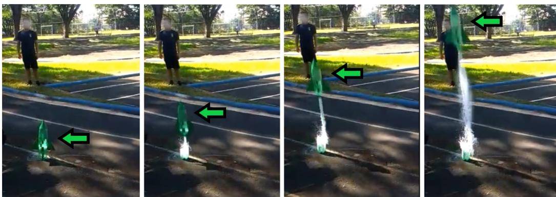
Figura 6. Sequência de subida do foguete de PET. As setas verdes apontam para o foguete em diferentes posições em cada imagem, conforme a subida devido o lançamento. FONTE: o autor, 2018.
