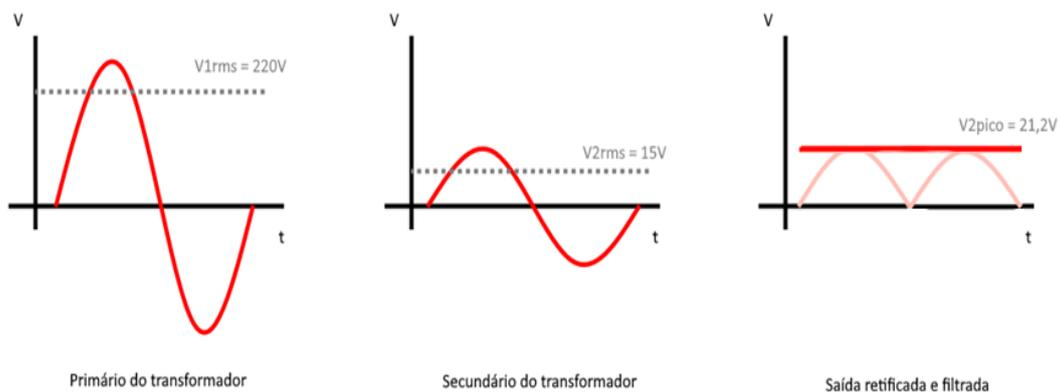
Figura 18 – Etapas para obtenção de uma fonte CC a partir da rede elétrica
