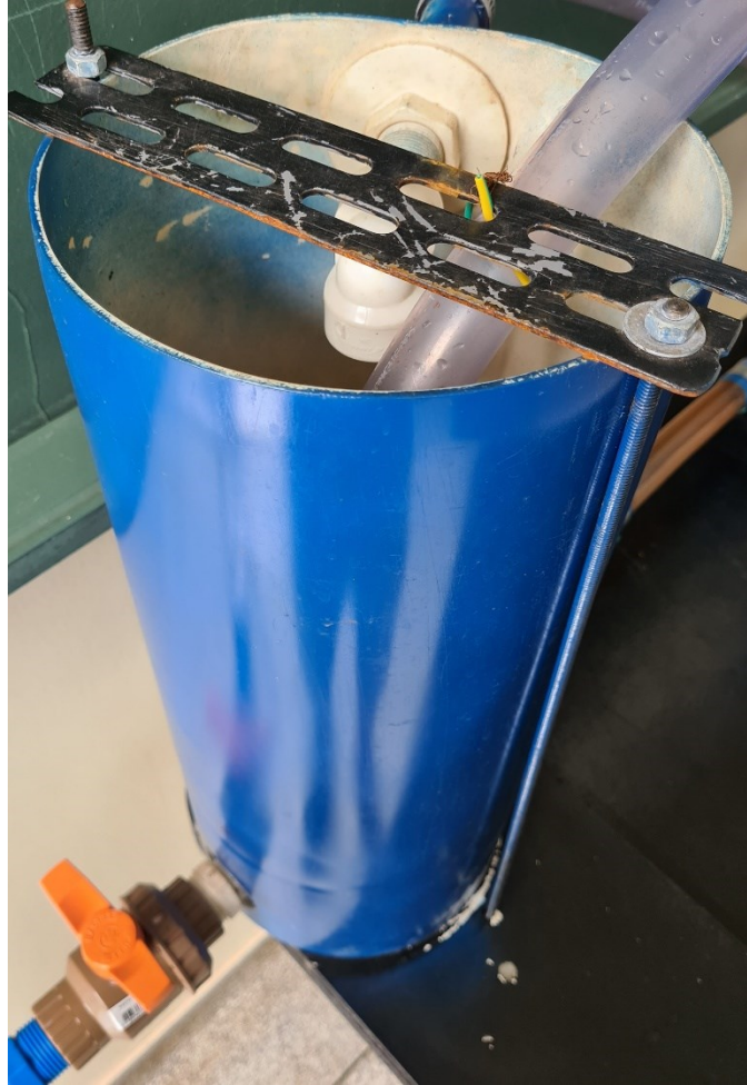
Figura 3.5 - Tanque utilizado para o fornecimento de água ao sistema.
