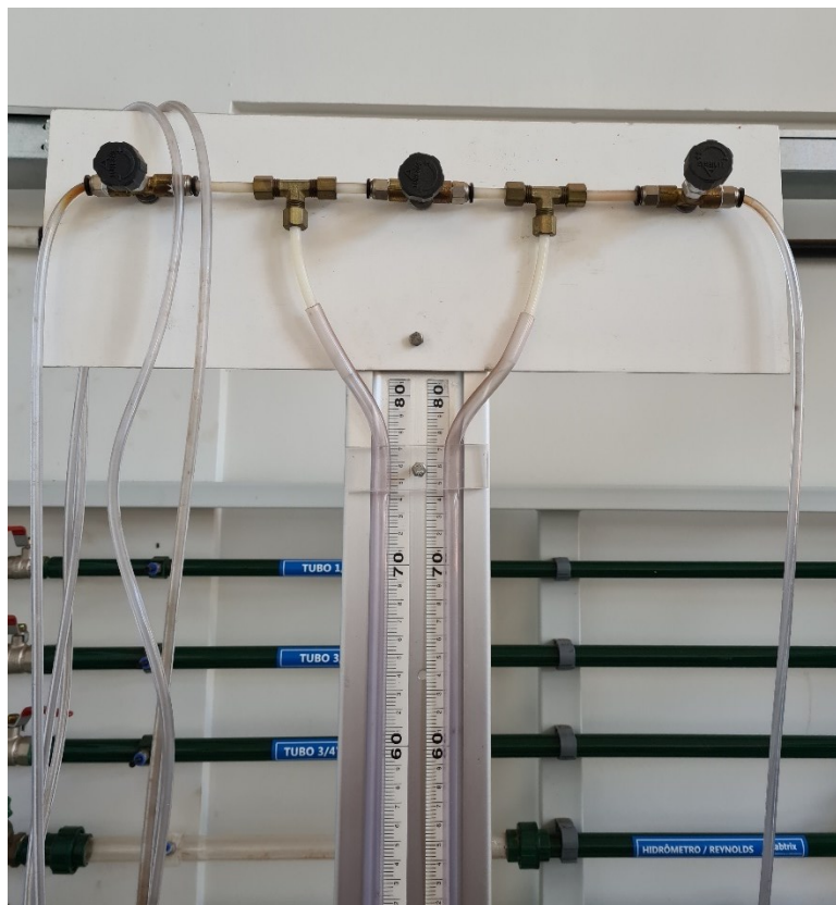
Figura 3.13 - Manômetro diferencial utilizado para avaliação da queda de pressão no tubo Venturi.
