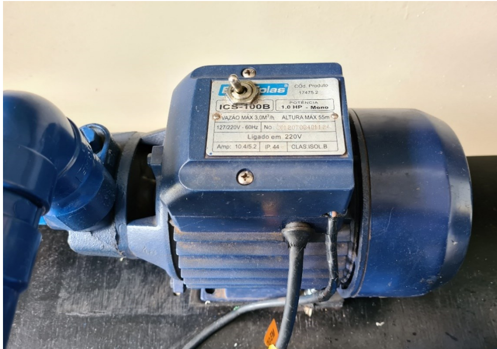
Figura 3.6 - Bomba centrífuga utilizada para recirculação de água do sistema.
