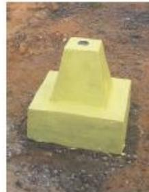
Marco geodésico padrão IBGE, com disco de centragem forçada e parafuso universal.
