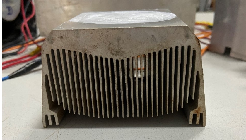
Figura 3.4 – Dissipador utilizado no terceiro sistema montado, conectado às faces frias das pastilhas Peltier.
