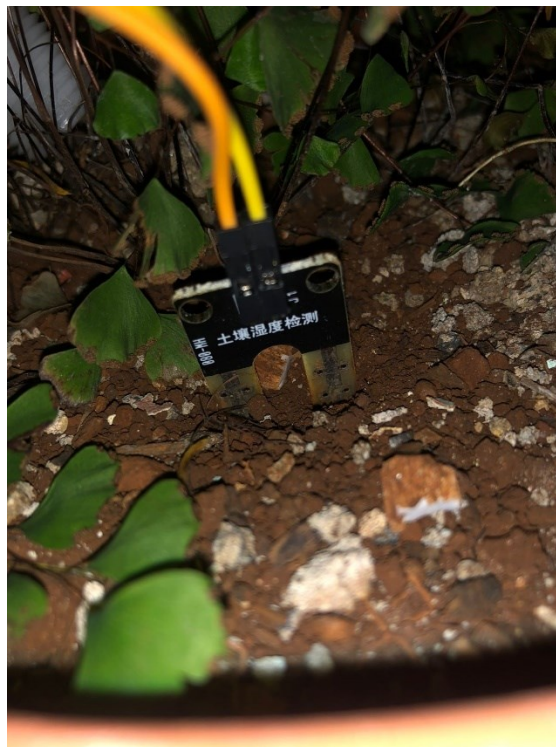
Figura 31 – Sensor de umidade fixado no solo.
