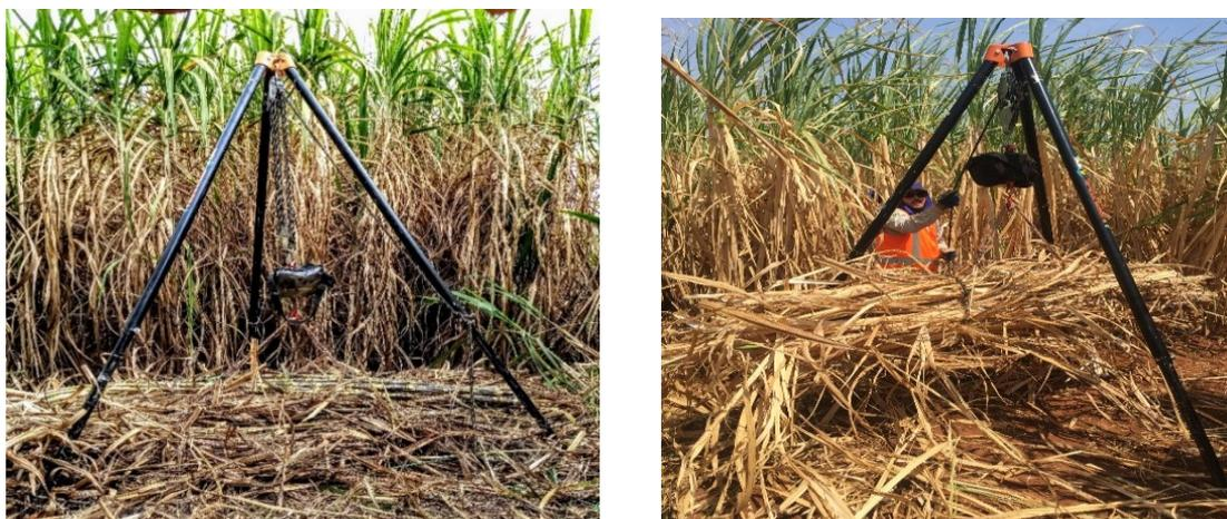
Figura 14 Pesagem das canas colhidas utilizando-se balança acoplada à um tripé de sustentação
