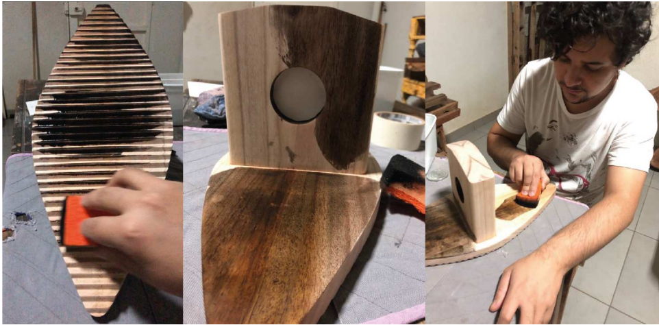
FIGURA 27: Painel de imagens dia 9 - Procedimento de ebanização da madeira. Ferramenta auxiliar esponja. Fonte: Autor.
