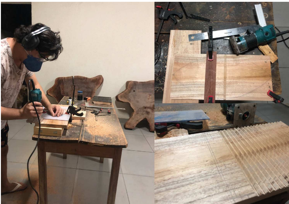
FIGURA 22: Pannel de imagens dia 4 - Usinagem da peça do assento para criar a textura por meio de zigzag. Ferramenta auxiliar tupia elétrica e fresa em angulação.
