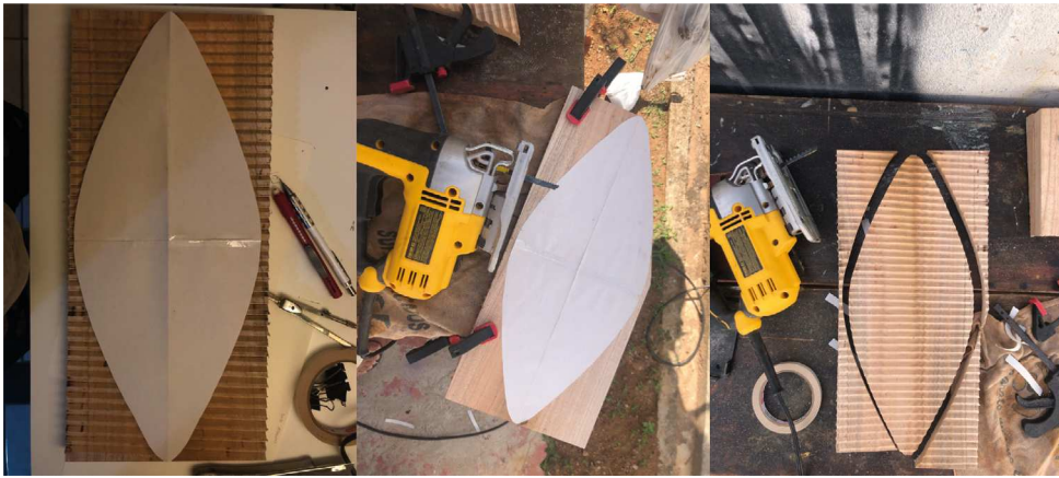
FIGURA 23: Pannel de imagens dia 5 - Usinagem da madeira com molde em papel do assento. Ferramenta auxiliar tico-tico.
