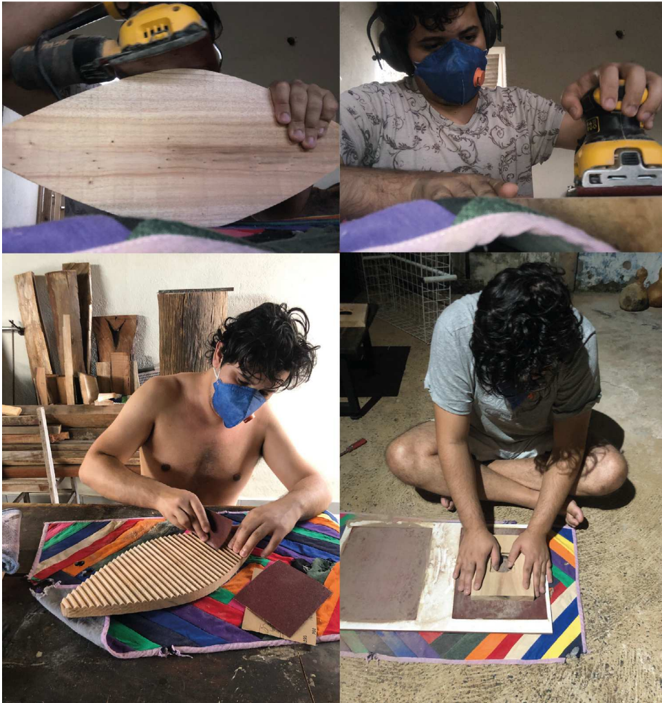
FIGURA 25: Painel de imagens dia 7 - Procedimento de lixagem das peças. Ferramenta auxiliar lixadeira orbital e gabarito com lixa.
