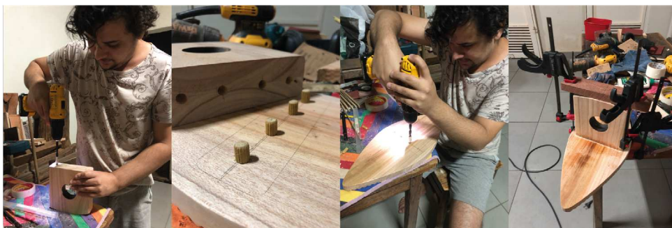
FIGURA 26: Painel de imagens dia 8 - Montagem e colagem do banco. Ferramenta auxiliar furadeira e broca 8 para cavilha.
