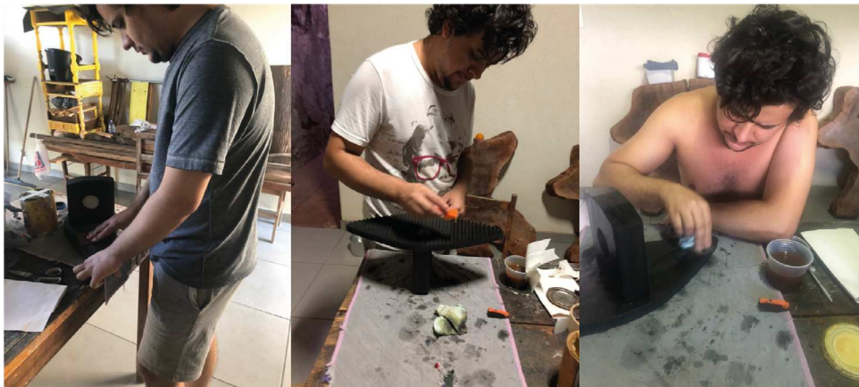
FIGURA 28: Painel de imagens dia 10 - Acabamento final, impermeabilização da madeira com verniz. Fonte: Autor.
