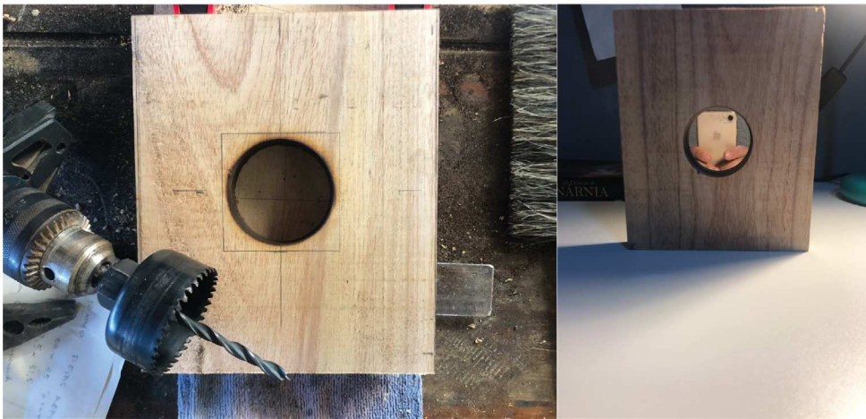
FIGURA 24: Pannel de imagens dia 6 - Usinagem da peça do pé, marcação do vazado do espelho e furação, colagem do espelho na peça. Ferramenta auxiliar furadeira e broca serra-copo.
