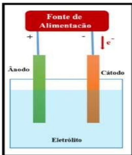
Figura 1 - Modelo simplificado de um reator eletrolítico.
