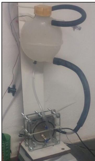
Figura 9 - Célula eletrolítica e o reservatório utilizado.
