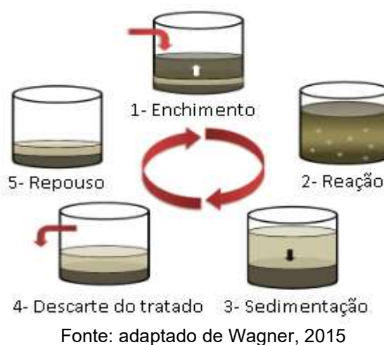
Figura 3 - Representação esquemática do ciclo operacional do RBS para remoção de matéria orgânica (MO)
