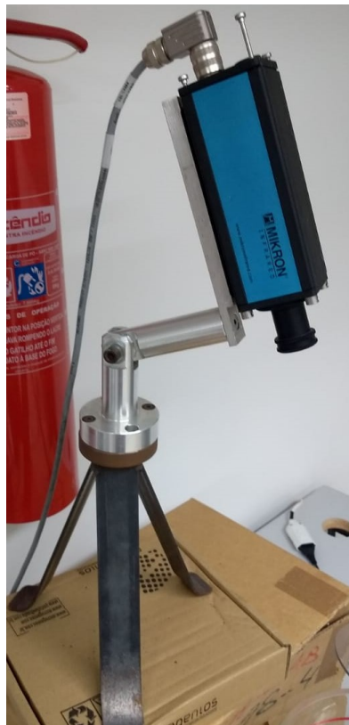
Figura A.1: Pirômetro MI-PE 140 com infravermelho, fabricado pela empresa Mikron.
