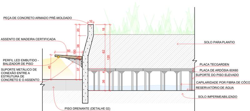
**DETALHE 03 - CANTEIRO ALTO - BANCO ACLOPADO E SISTEMA TECGARDEN**
