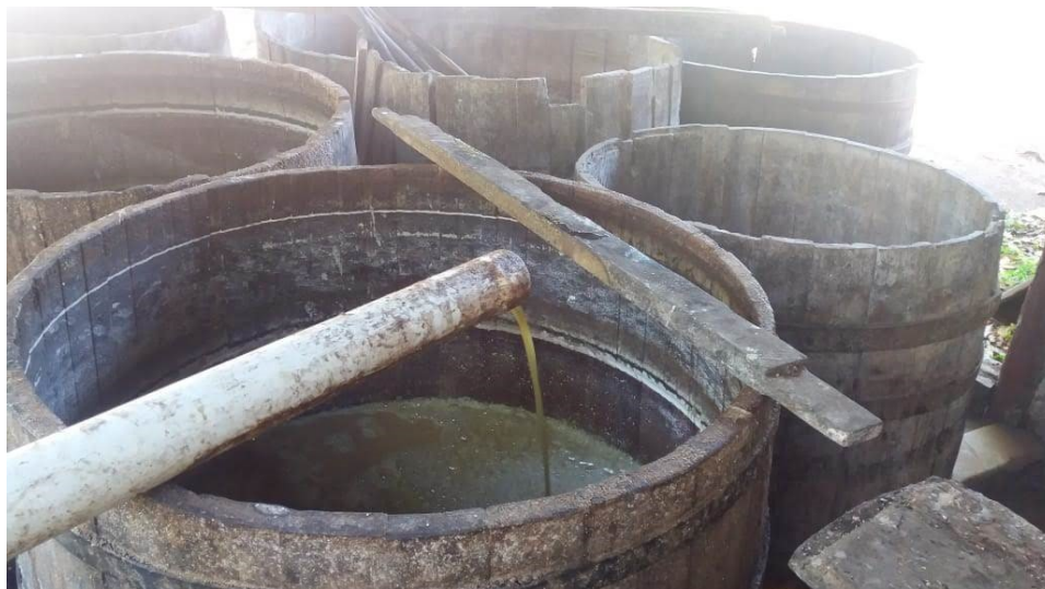
Foto 11: Tonel de fermentação recebendo o caldo da cana-de-açúcar que dará origem à cachaça artesanal.
