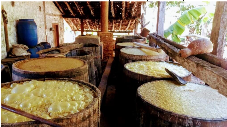
Foto 12: Toneis com o caldo da cana-de-açúcar em processo de fermentação com as leveduras transformando o caldo para a destilação da cachaça
