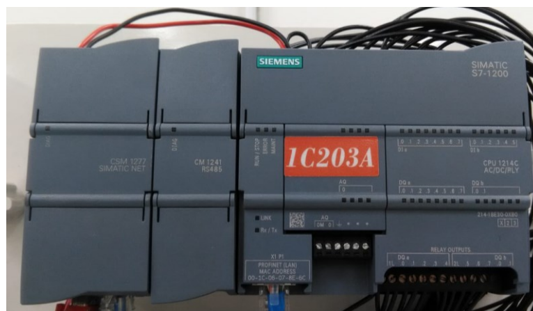
Figura 40 – Controlador Siemens SIMATIC S7-1200-1214C do laboratório.
