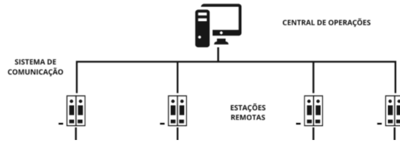
Figura 31 – Elementos de um sistema SCADA.
