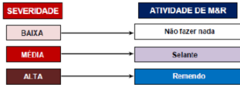
Figura 23 — Árvore de decisão para trincas transversais
