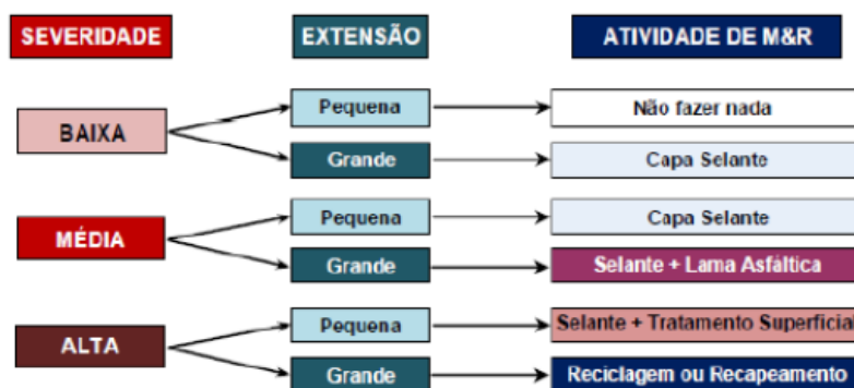
Figura 19 — Árvore de decisão para trincas em blocos
