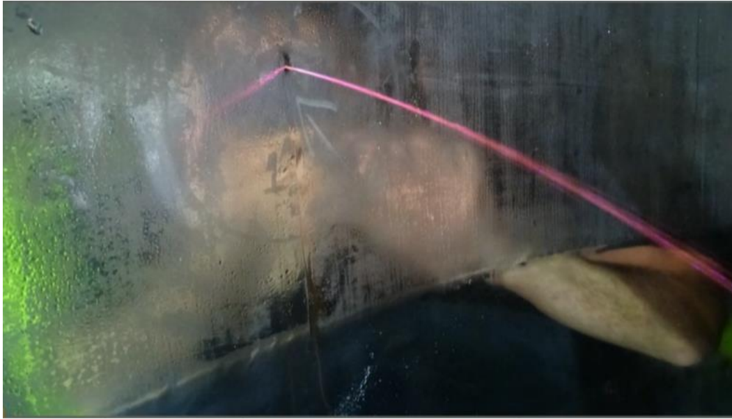
Figura 8: Ponto de vazamento no tanque 10 da cervejaria Backer encontrado em perícia realizada no ano de 2020 pela polícia Civil do Estado de Minas Gerais. (FONTE: Adaptado de https://g1.globo.com/fantastico/noticia/2020/06/14/caso-backer-fantastico-mostra-com-exclusividade-como-a-contaminacao-das-cervejas-aconteceu.ghtml , 2020. )
