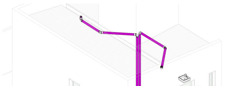
Figura 35. Descidas de pluvial de 100mm
