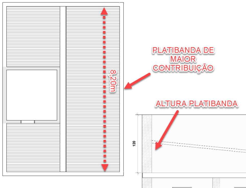
Figura 28. Dimensões da platibanda para cálculo da área de contribuição
