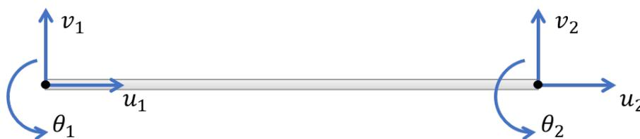
Cada um desses deslocamentos é denominado grau de liberdade. Para o elemento de viga, têm-se três graus de liberdade por nó. Para um caso tridimensional, aumenta para seis graus de liberdade por nó.
