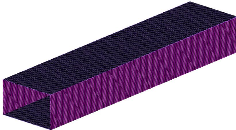
Para a análise da viga são adotados elementos numéricos de 5 mm por 5 mm, uma vez que, dadas as dimensões da peça, acredita-se que tal tamanho de elemento corresponda a um refinamento adequado, contabilizando um total de 37840 elementos na superfície da viga. Já os reforçadores são modelados como elementos unidimensionais, visto que o seu comprimento é muito maior do que as
