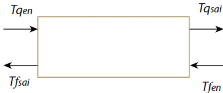
**Figura 1:** Princípio de um trocador de calor (ORGEDA; YOSHI, 2021).
