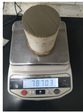
Figura 4: Ensaio de índice de consistência e densidade de massa
