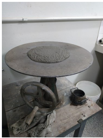
Figura 4: Ensaio de índice de consistência e densidade de massa
