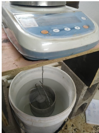
Figura 6: Método para obtenção da massa saturada submersa
