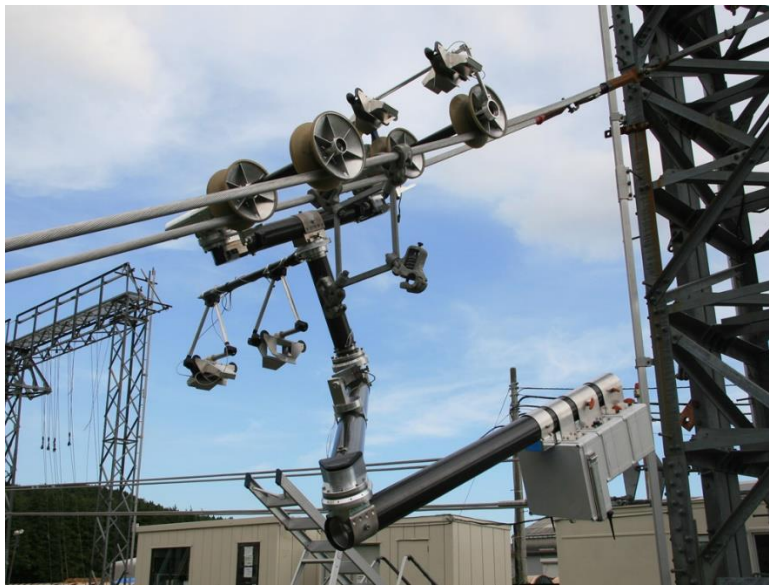
Figura 25 – Protótipo robótico Expliner.
