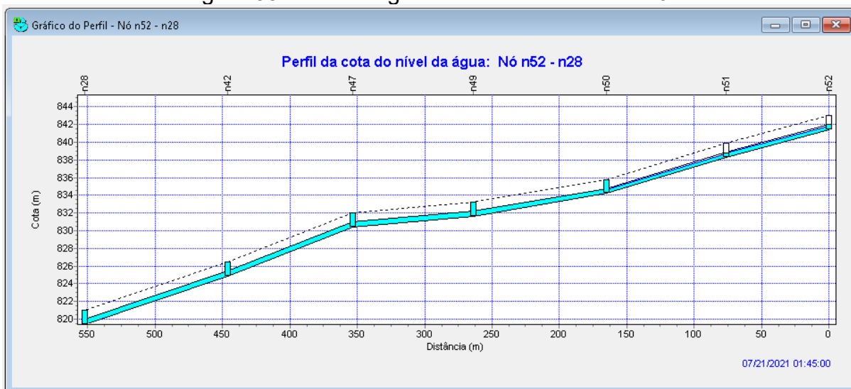
Figura 35 - Perfil longitudinal trecho Sub-bacia 04
