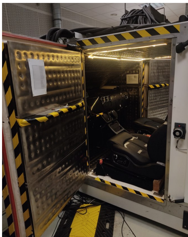
Figura 11: Bancada de testes SITHER instalada em um dos laboratórios do grupo PSA (O autor).
