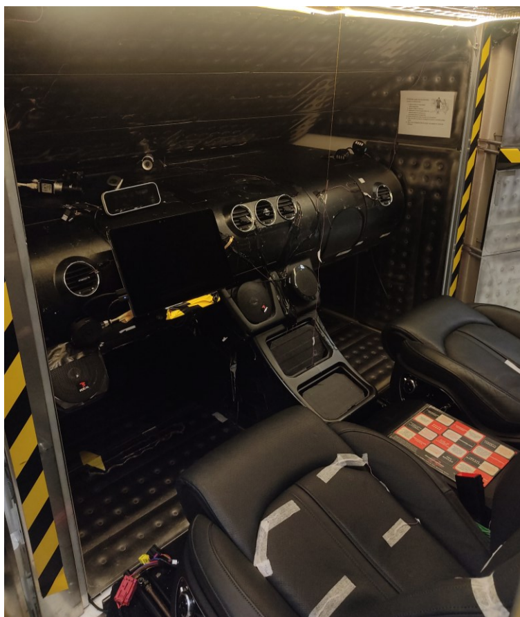
Figura 12: O interior do simulador possui os principais elementos encontrados no interior da cabine de um veículo real (O autor).
