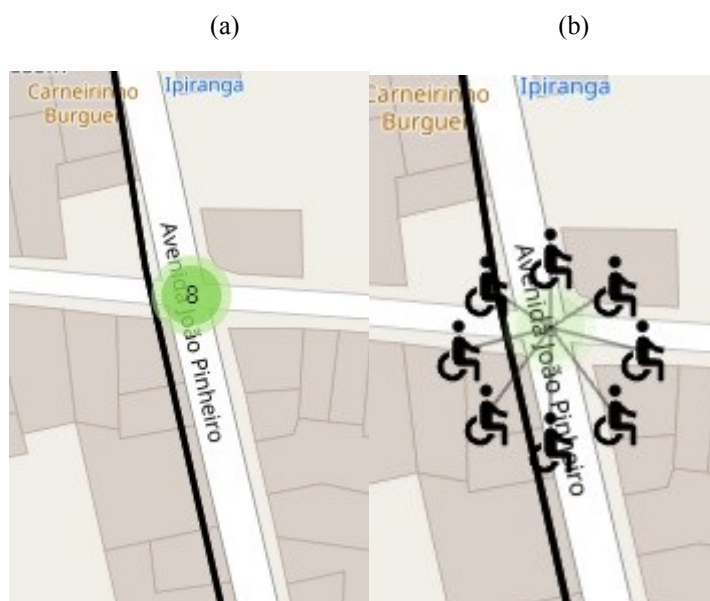
Figura 25 – Aglutinação das feições em uma região no mapa do Shared Gis com 8 rampas – (a) Pontos concentrados (b) Expansão da área para visualização dos pontos
