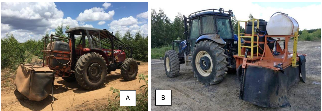
Figura 1. Pulverizadores avaliados, Convencional (A) e Asa de Morcego (B).
