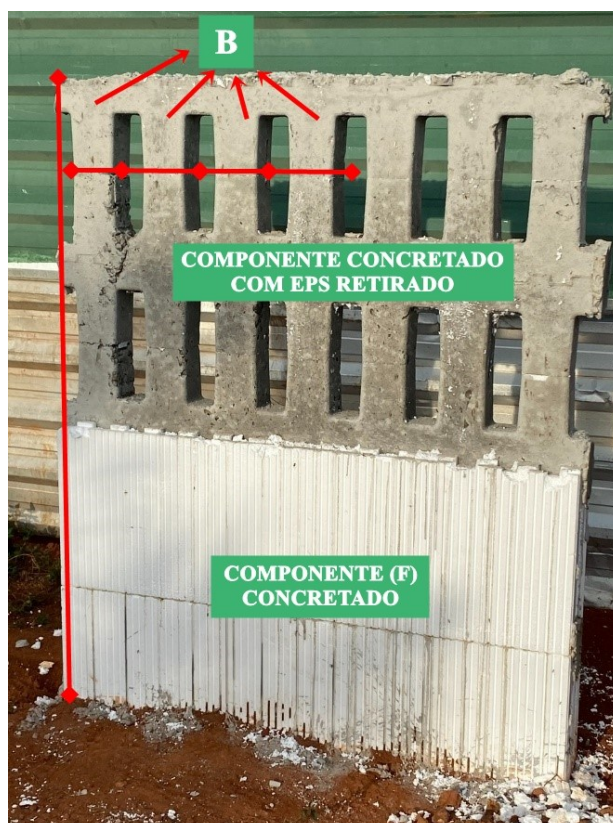
Figura 30 - Disposição vertical com 10 furos e horizontal com concreto armado no painel ICF finalizado.
