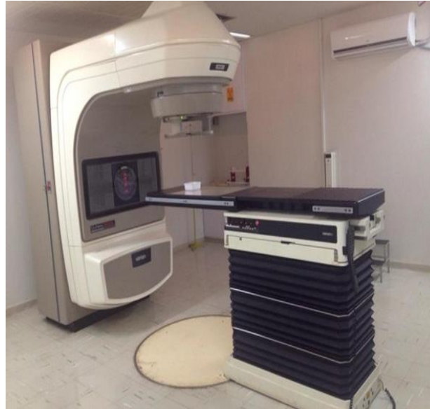
Figura 1: Irradiação das amostras com o acelerador linear Clinac 600C Varian®.
