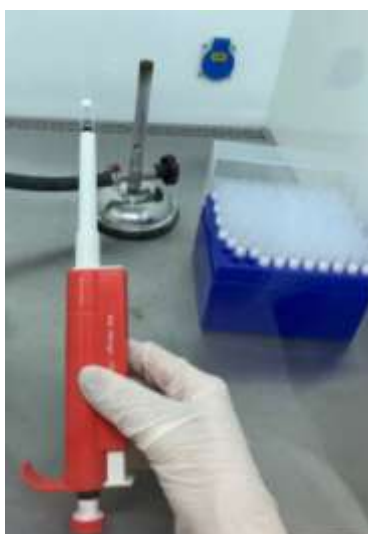
Figura 21. Pipeta calibrada para dispensar 1000 µl, em seguida 500 µl e ponteiras descartáveis esterilizadas.
