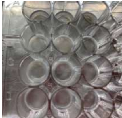
Figura 29. Biofilme formado no fundo da placa de 48 poços.
