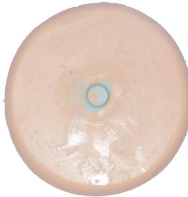
**Figura 3:** Matriz de silicone por adição (2x4mm) para confecção das amostras para o teste de resistência à tração diametral.
