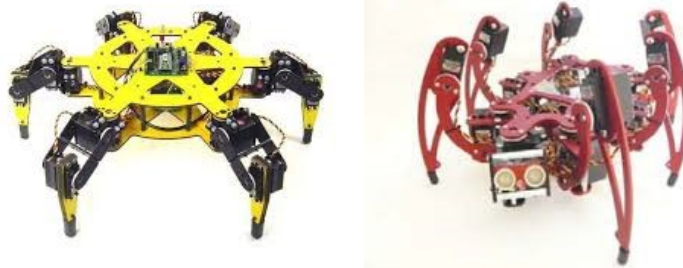
Figura 5 - Hexápode hexagonal e hexápode retangular respectivamente.
