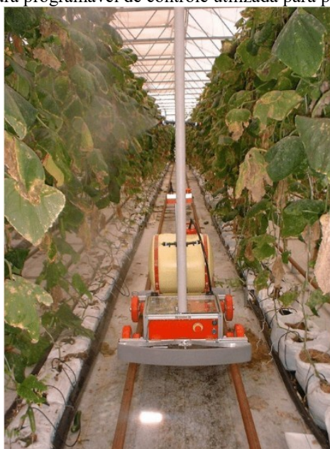
Figura 14- Estrutura programável de controle utilizada para pulverização.
