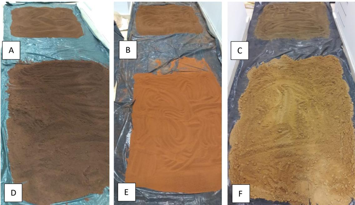
**Figura 4:** Secagem a sombra das amostras de solos coletadas dos horizontes A (A, B e C) e Bw (D, E e F) dos solos LVwf (A e D), LVw (B e E) e LAw (C e F), respectivamente.
