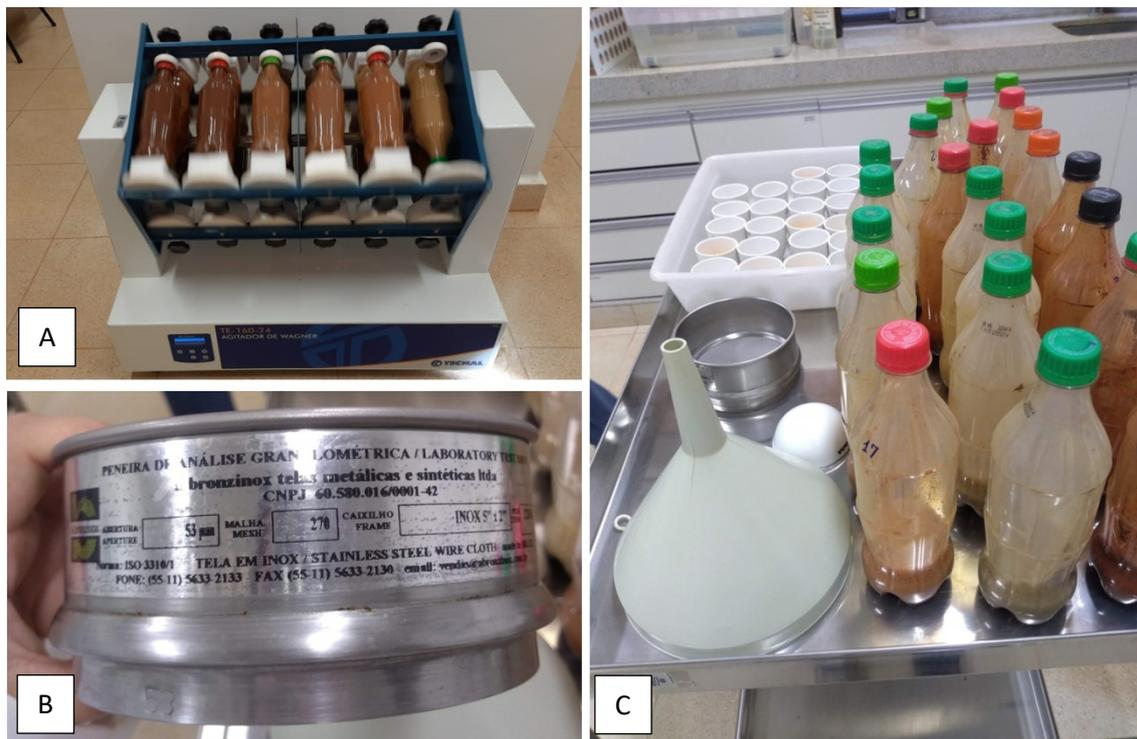
**Figura 1:** Análise granulométrica. (A) dispersão física das amostras por 16 horas em agitador de 360° do tipo Wagner; (B): peneira de abertura de malha de 0,053 mm utilizada para separação da fração areia; (C) materiais utilizados na análise para separação da fração areia: frascos contendo o solo disperso, funil, coletor de porcelana, peneira e cadinhos para coleta dos materiais.
