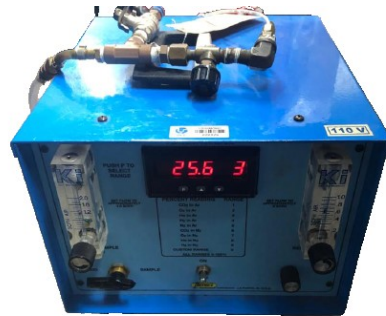
Figura 4.1 - Analisador de gases utilizado para verificação do teor de Hélio no gás de proteção
