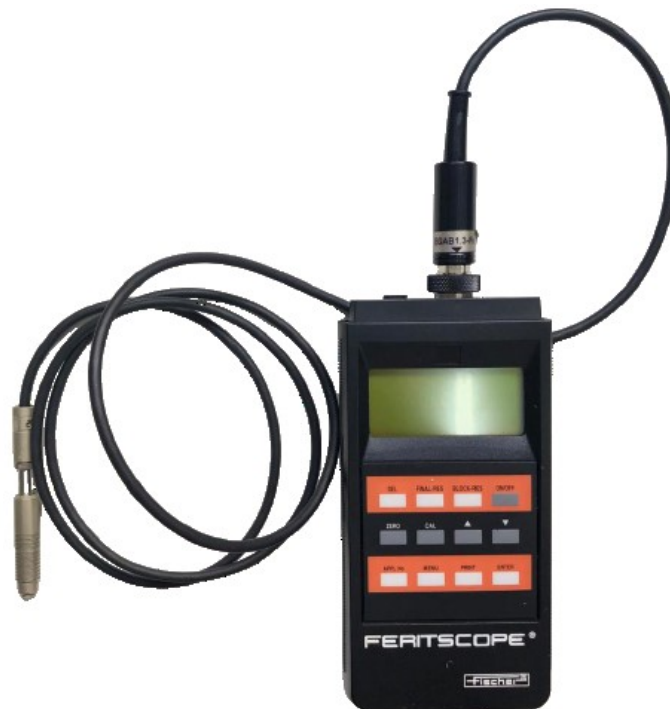
Figura 3.11 - Ferritoscópio utilizado para medições do teor de ferrita
