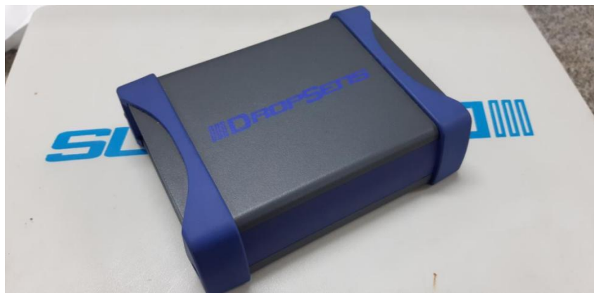
Figura 15. Potenciostato Dropsens \mu STAT300 utilizado nas análises eletroanalíticas.
