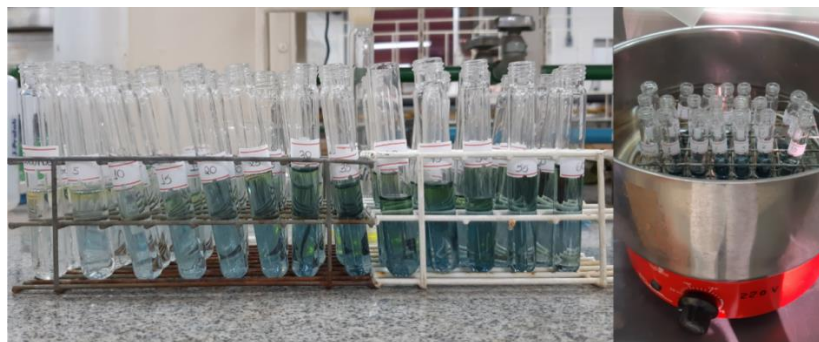
Figura 17. Preparo das soluções em triplicata em concentrações crescentes para construção da curva analítica visando à determinação do teor de fenóis totais.
