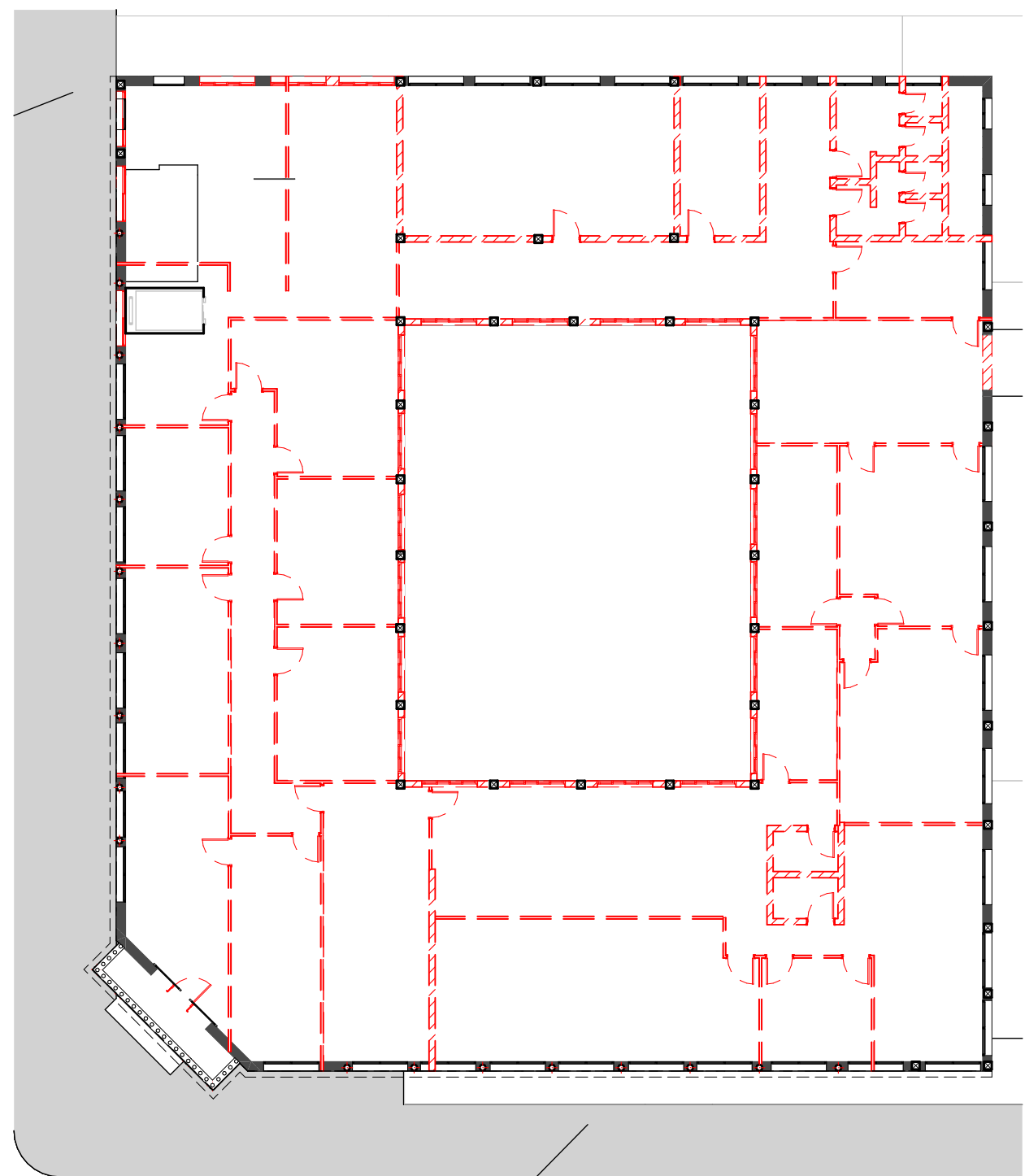
DEMOLIR 3° PAV. Escala: 1:200
