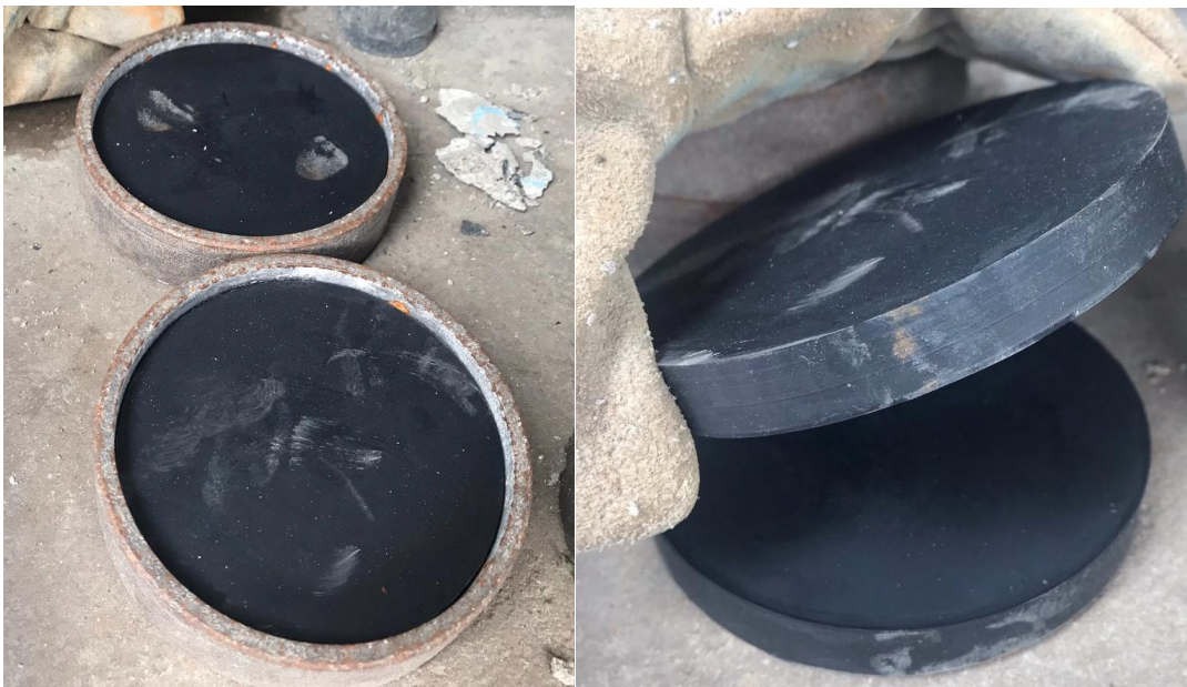
Figura 27 - Neoprene utilizado no ensaio
