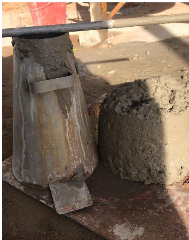
Figura 25 - Ensaio de abatimento do tronco de cone
