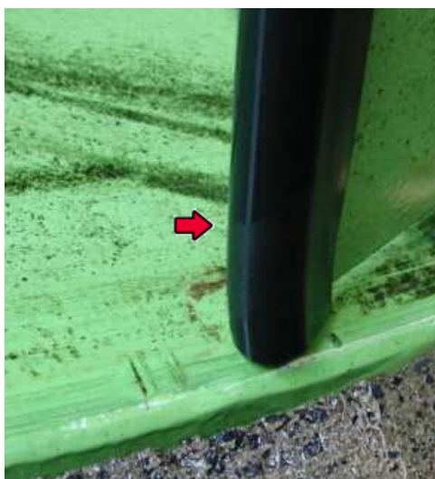
Figura 2.8 – Proteções emborrachadas recomendadas para as extremidades dos helicoides. Fonte: adaptado de Kibel e Coe (2007).
