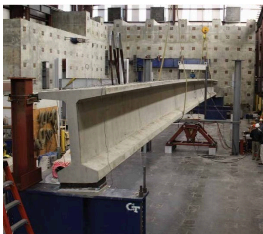
Figura 2.11 – Viga PCI BT-54 posicionada para experimento
