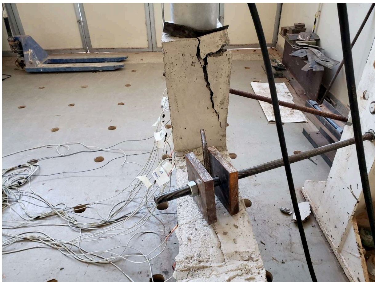
Figura 38 – Ruptura do bloco B20L por esmagamento do concreto no topo do pilar
