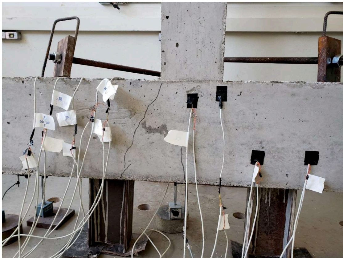
Figura 31 – Propagação das fissuras no bloco B16-12,5S
