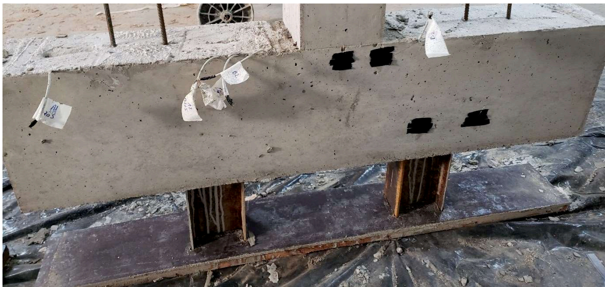
Figura 25 – Posicionamento dos extensômetros na face lateral do bloco
