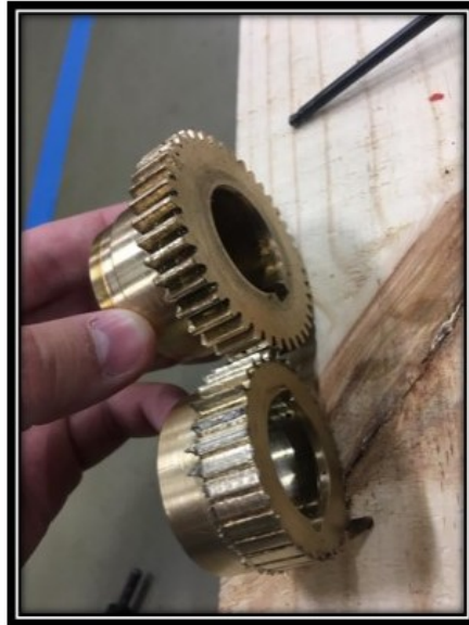
Figura 3.8 – Engrenagens de latão desgastadas confeccionadas sob pedido para atendimento urgente pela equipe de Sub-room.
