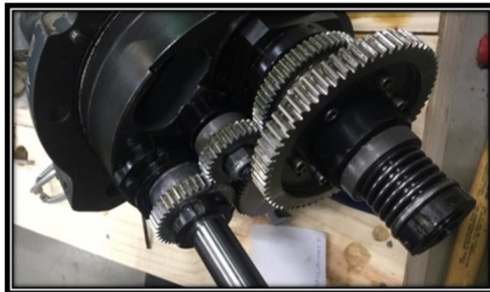
Figura 3.9 – Acionamento interno de grupo onde está localizados as engrenagens.
