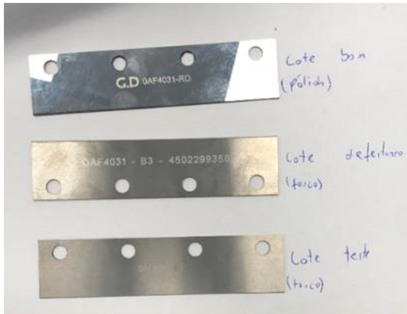
Figura 3.17 – Os três lotes de facas estudados e analisados para comprovação de falha de fabricação e ressarcimento posterior.
